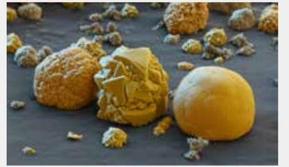
显微镜下的各种锂离子电池正极材料。
