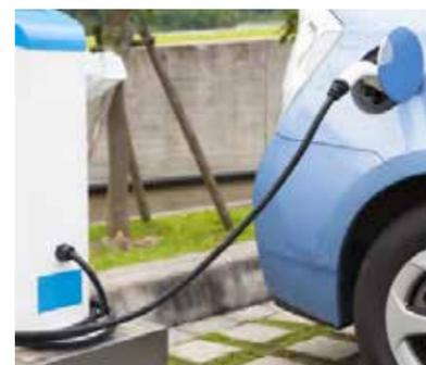
Ultramid® 聚酰胺工程塑料被用于电动车充电系统接头和线束的制造。
